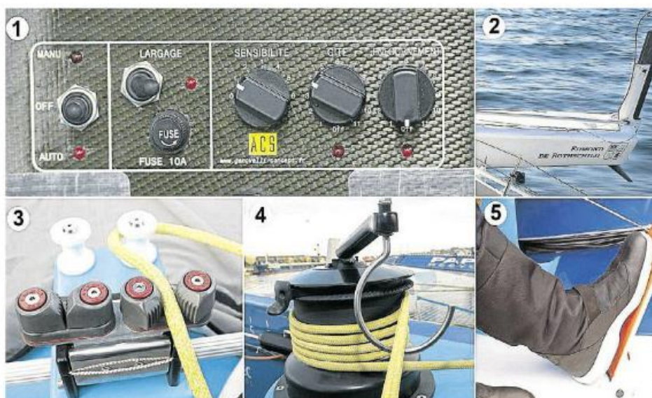
1. Le boîtier anticap size (ACS). 2. Les safrans en T d'Edmond de Rothschild ; 3. Les taquets largables ; 4. La manivelle croc. 5. La pédale d'urgence.
