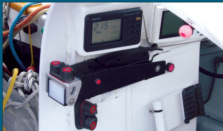
Le système basculant qui commande le largage d'écoute des voiles d'avant.
