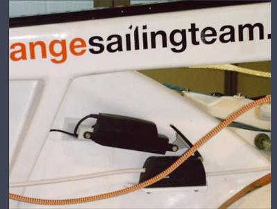
L'organe hydraulique ne sécurise pas l'écoute par lui même, c'est une électrovanne de vérin hydraulique conçue pour contrôler les cylindres hydrauliques, line drivers ou winchs captifs.
